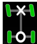
Блокировка переднего дифференциала Задний дифференциал
