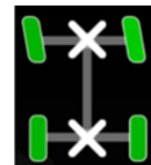
Блокировка переднего дифференциала Блокировка заднего дифференциала
